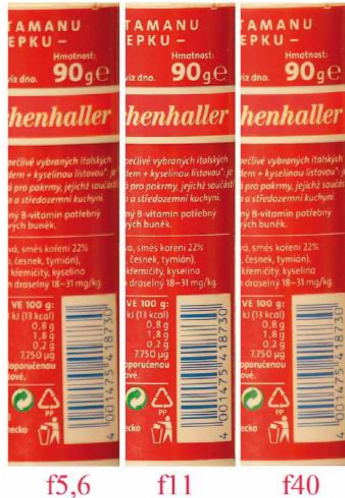
Obr. 43 Vliv zaclonění na celkovou ostrost obrazu v místě zaostření obrazu.
