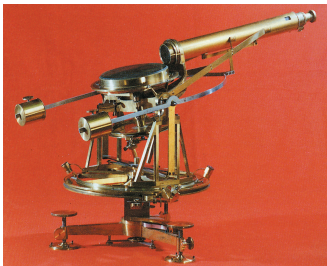
První mřížkový spektroskop, Fraunhofer, 1821
