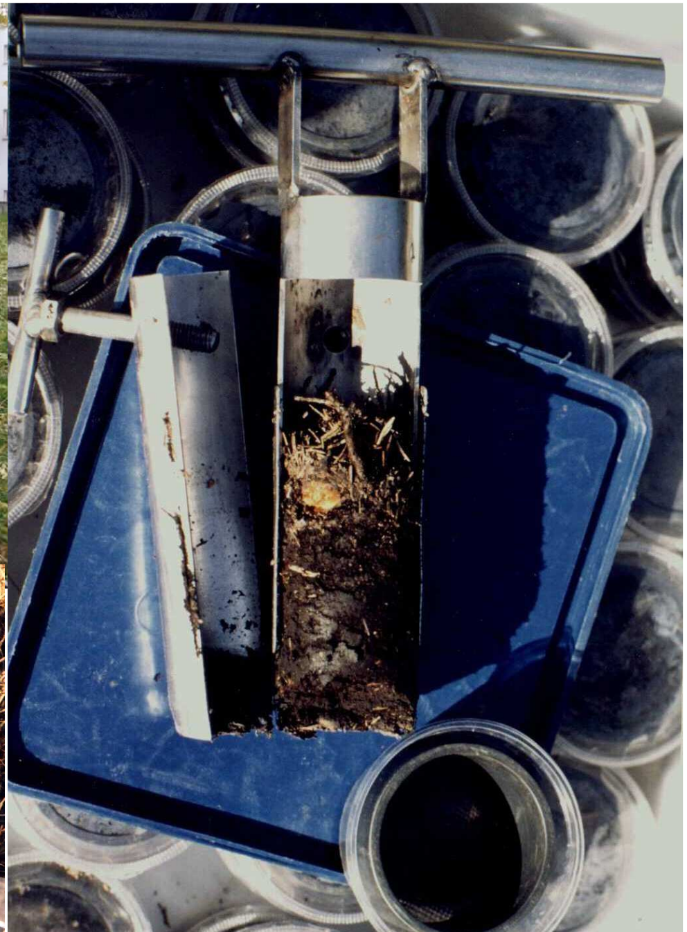
Odběr půdy pro extrakci roudic pomocí půdní sondy
