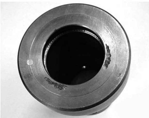
Obr.3. Štěrbínová koroze korozivzdorné oceli.
