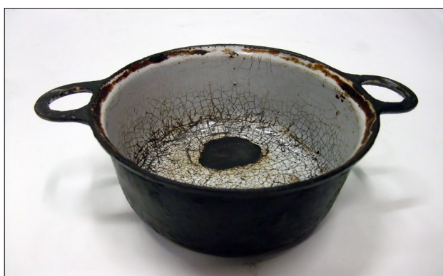
Obr. 13: Litinové nádobí, poškozený smalt uvnitř nádoby
