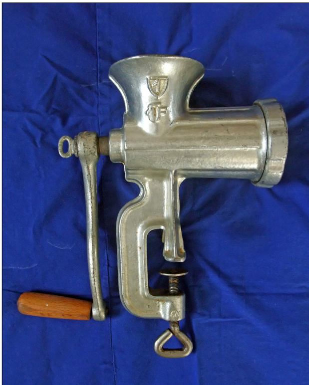
Obr. 14: Litinový mlýnek na maso s pocínovaným povrchem
