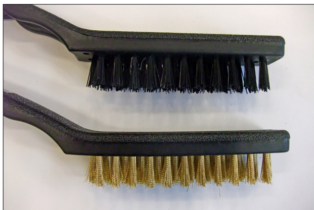
Obr. 12: Pomůcky k mechanickému čištění povrchu předmětů.
