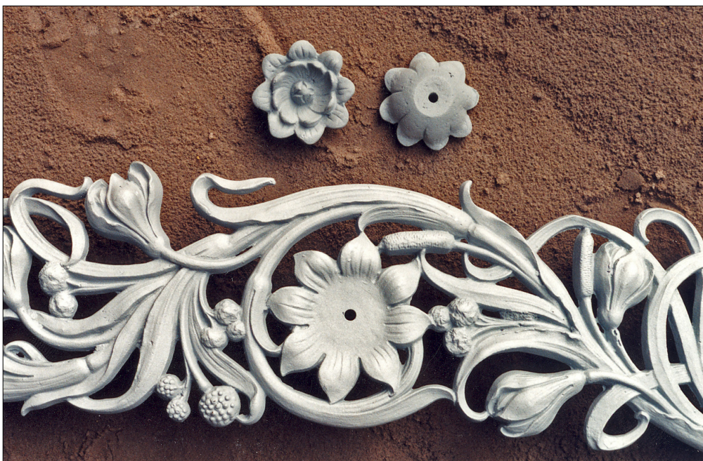
Obr. 15: Litinové dekorativní prvky s rostlinným motivem, povrch po otryskání a žárovém zinkování, připraveno k nátěru
