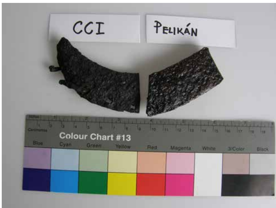
Obr. 4: Porovnání vzhledu dvou různých tanátovacích receptur (CCI – Canadian Conservation Institute, receptura dle Pelikána - 20% roztok s úpravou pH)
