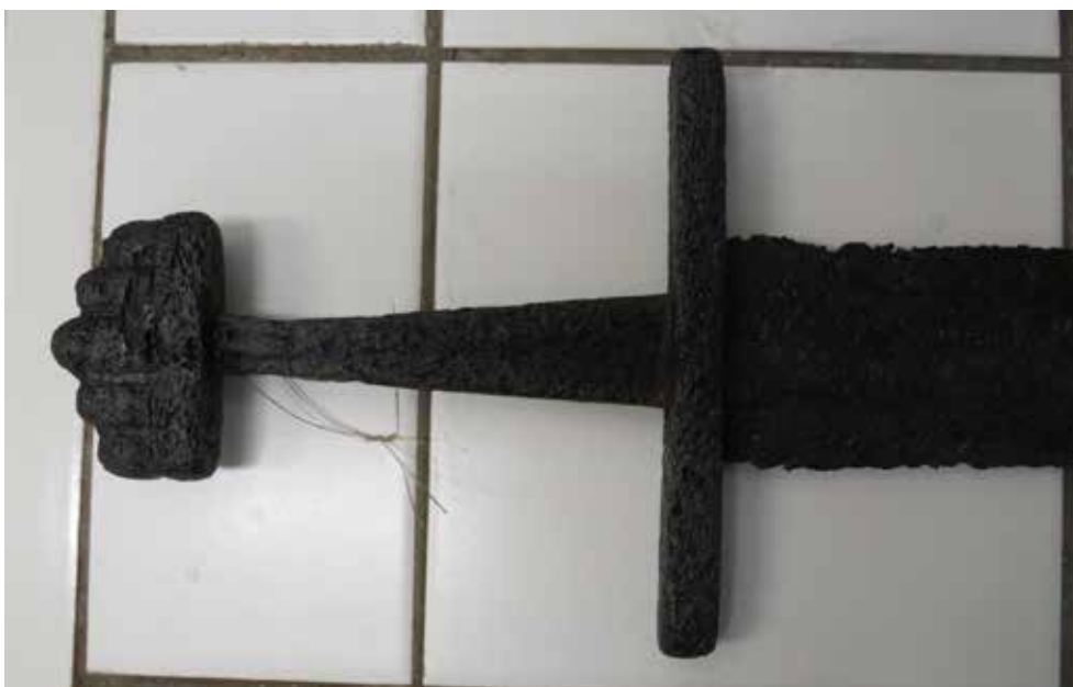
Obr. 12: Rukojeť meče po aplikaci tanátovacího roztoku, viditelné sjednocení barevnosti povrchu s využitím přehřátí meče pro zlepšení reakce tanátovacího roztoku s kovovým jádrem předmětu
