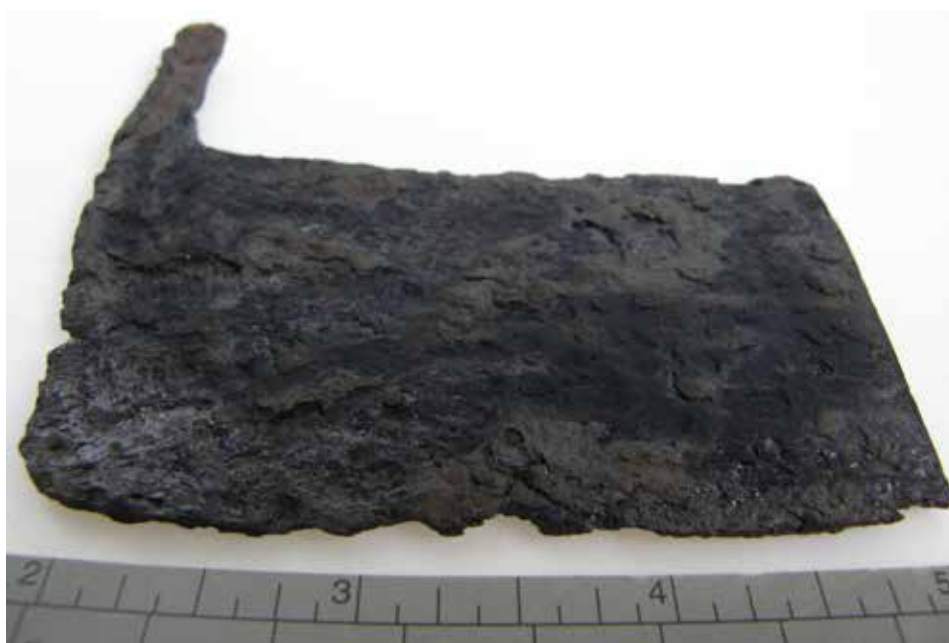
Obr. 9: Tanátový povlak vytvořený s nedostatečným přístupem vzduchu
