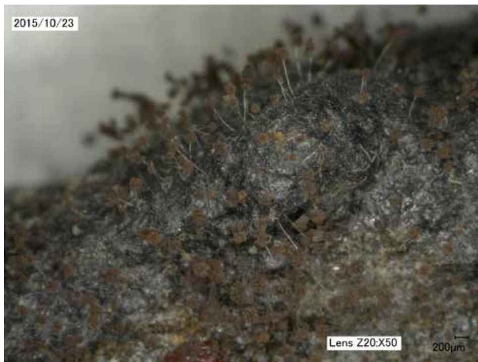
Obr. 5: Černá plíseň na tanátovém povlaku
