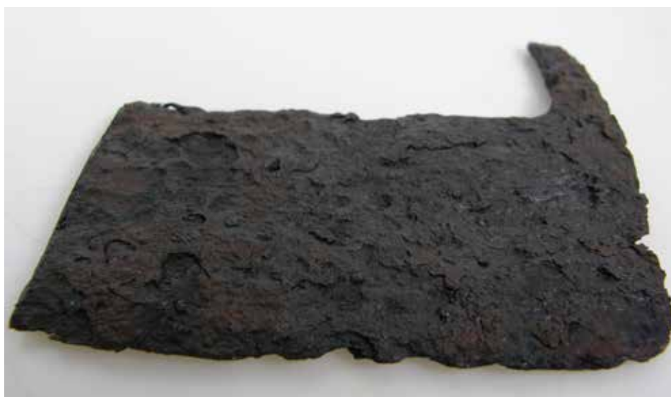
Obr. 10: Tanátový povlak s dostatečným přístupem vzduchu
