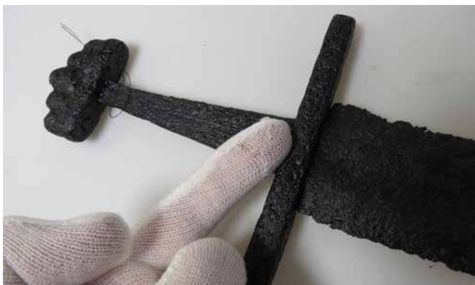
Obr. 15: Tanátový povlak s požadovanými fyzikálně-chemickými vlastnostmi, nezanechává stopu po otěru
