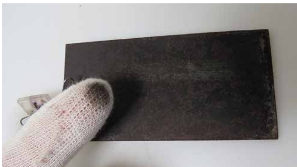
Obr. 15: Tanátový povlak vytvořený z tanátovacího roztoku o vysokém pH nemá dostatečnou stabilitu a zanechává výraznou stopu po otěru
