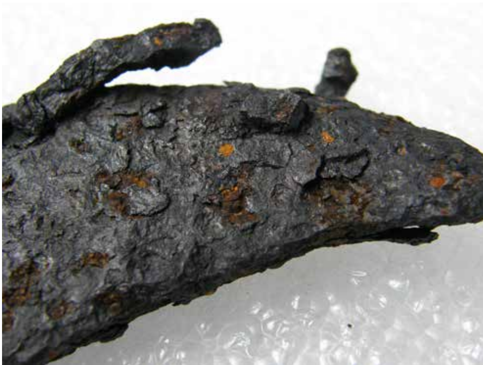
Obr. 8: Výsledný efekt po aplikaci tanátového povlaku bez předchozí stabilizace předmětu desalinací (koroze stimulovaná chloridy)
