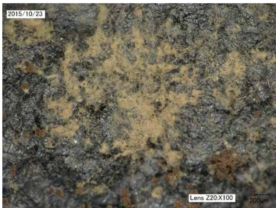
Obr. 6: Bílá plíseň na tanátovém povlaku
