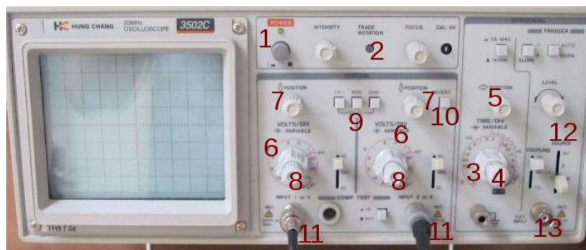
Obrázek 2: Osciloskop Hung chang 3502C. Čísla označují umístění ovládacích prvků zmíněných v textu. Knoflíky 4 a 8 jsou umístěny ve středu přepínačů 3 a 6.
