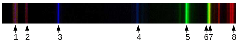
Obrázek 1: Upravená fotografie spektra rtuťové výbojky. Očíslovány jsou čáry, jejichž vlnové délky jsou uvedeny v tabulce 1.
