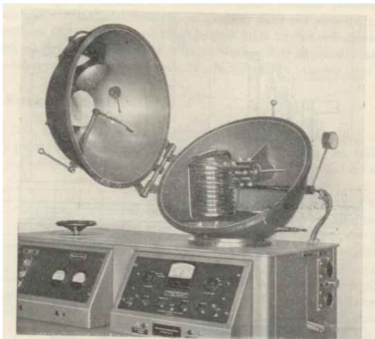
Obr. 12-79. Vákuová vysokoteplotná piecka so sklopným téglikom so stabilizovanou keramikou ZrO_2 a odporovým kúrením do 30 kW; najvyššia teplota 2000 °C; kapacita až 6 kg ocele; dosiahnuteľné vákuum 5 \cdot 10^{-6} torov (výrobca: High Vacuum Equipment Corp., Hingham—Mass., USA).
