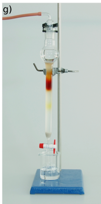
Obrázky 36e–h: Dělení azobarviv pomocí sloupcové chromatografie.
