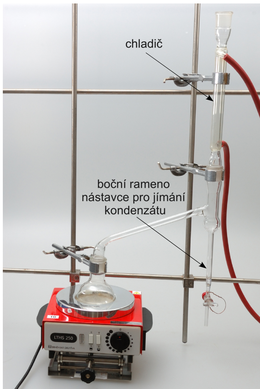
Obrázek 33: Aparatura pro azeotropní destilaci s rozpouštědly lehčími než voda.
