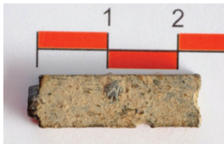
3. Literka ze slitiny olova s charakteristickou vrstvou korozních prvků
