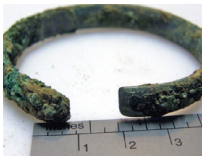
6. Měděný náramek s hrubou vrstvou korozních produktů neušlechtilé patiny
