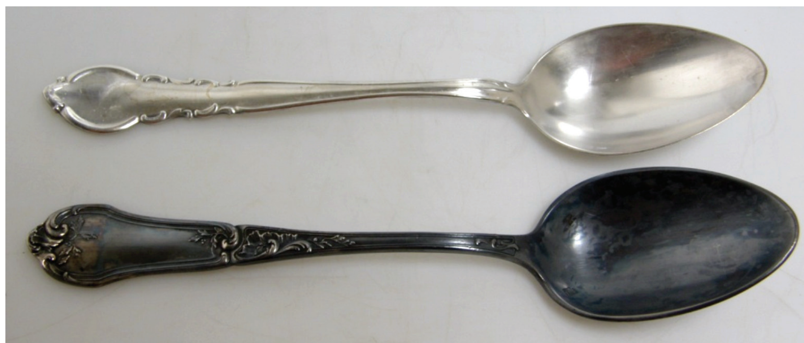
2. Postříbřené lžíce s a bez korozních produktů \text{Ag}_2\text{S}
