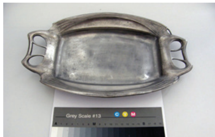
1. Tácek ze slitiny olova po odstranění korozních produktů
