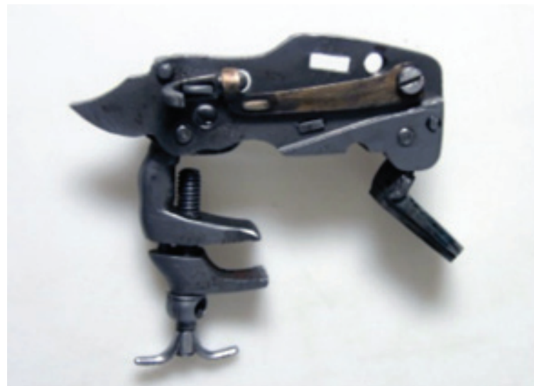
5. Kopie zámku předem nabíjené pušky bez korozních produktů
