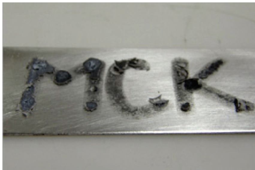
1. Hliníkový kupon poškozený roztokem \text{HgCl}_2 ve tvaru zkratky Metodického centra konzervace
