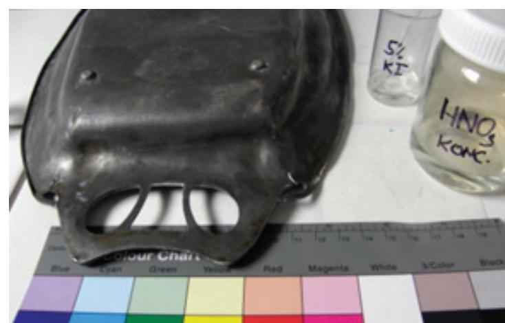
2. Tácek ze slitiny olova s vrstvou korozních produktů
