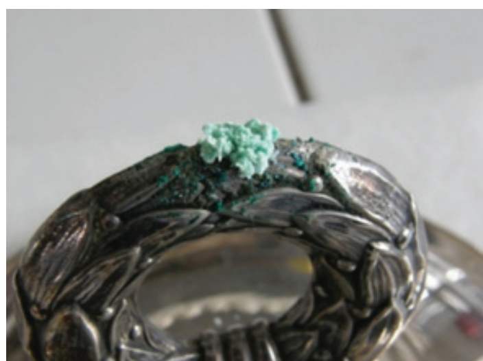
5. Korozí mosazného jádra, poškozující niklovou povrchovou úpravu vítězného poháru
