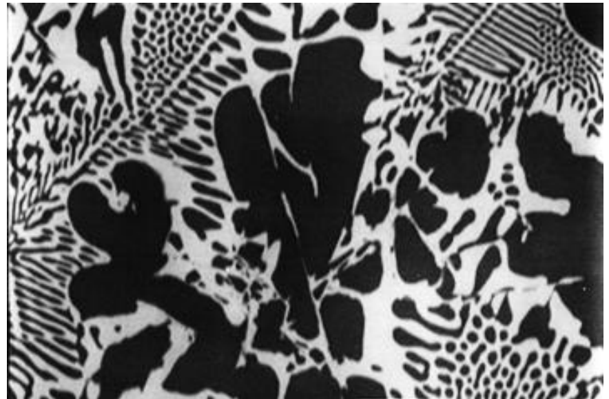
Obraz v režimu BSE slitina Al-Cu Al ( Z = 13 ) – tmavší oblasti Cu ( Z = 29 ) – světlejší oblasti
