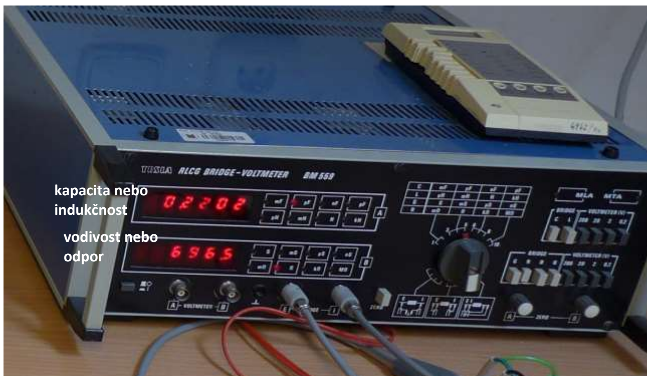
Obr. 6 Detail přístroje obsahující automatický střídavý most pro měření odporu, kapacit a indukčnosti.
