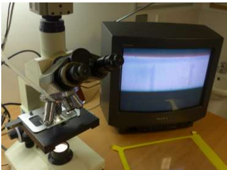
Obr. 10 Mikroskop s monitorem a Bürkerovou komůrkou pod objektivem ukazující měřítko 50 \mu\text{m} .
