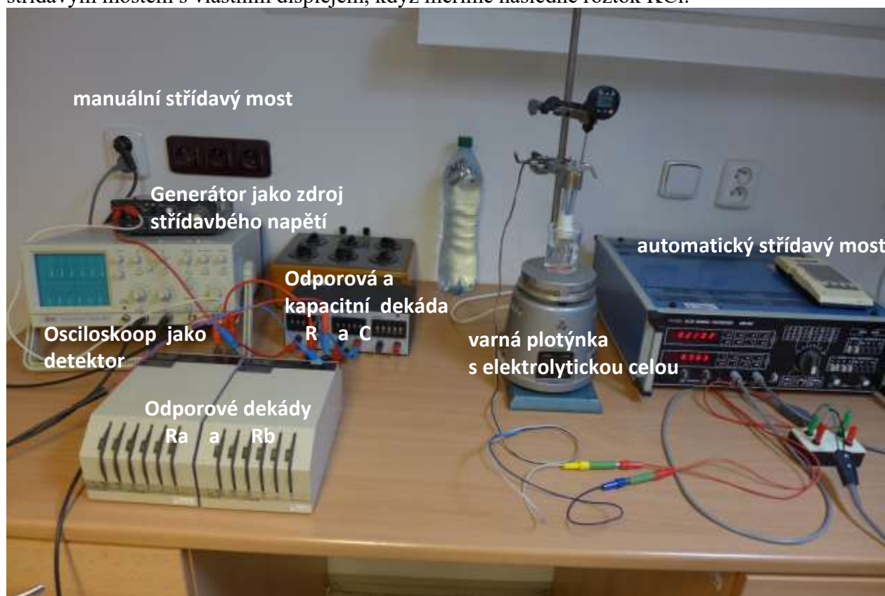
Obr. 1 Celkové zařízení střídavých mostů pro měření odporu pomocí střídavého napětí. Vlevo: sestavený střídavý most podle schématu v návodu; vpravo: automatický střídavý most.
