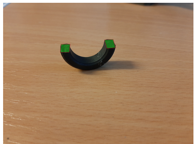
(b) Feromagnetické jadro transformátoru. Zelená farba vyznačuje plochu, ktorou prechádza magnetický tok.
