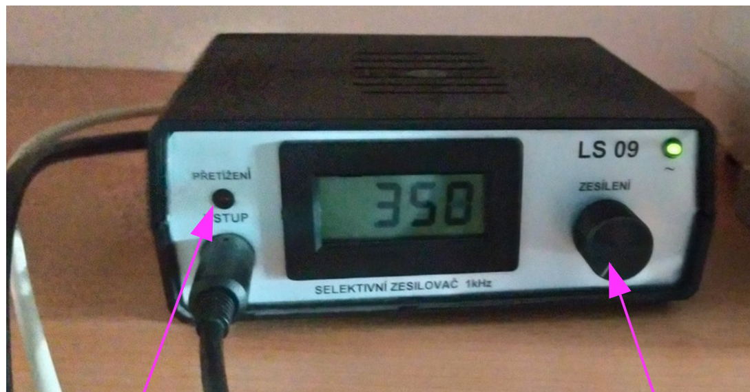
Obr. 3 Zesilovač signálu z detektoru (selektivně zesiluje jen signál frekvence 1kHz)
