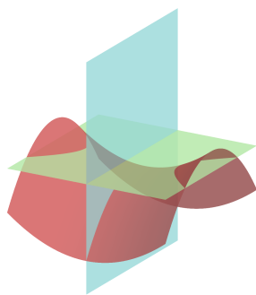
Obrázek 24.6: Řezy hyperbolického paraboloidu
