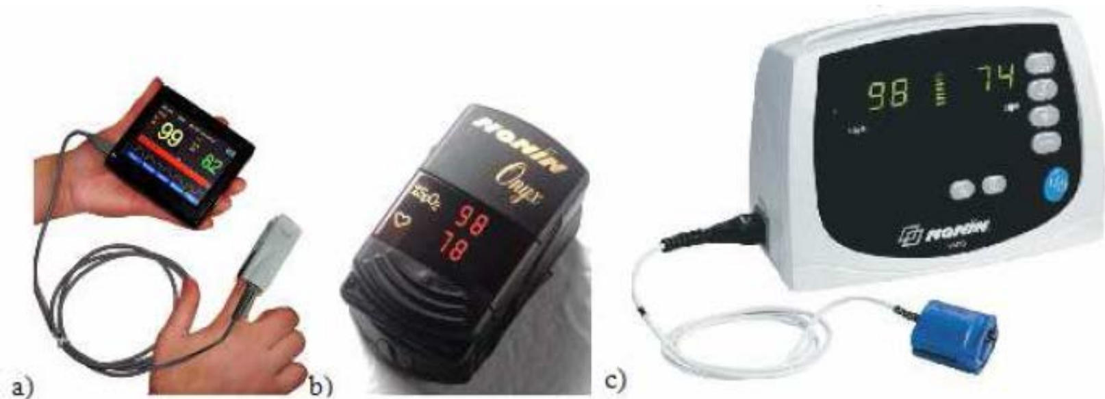
Obr. 10 Různé podoby pulsních oxymetrů, a) příruční, b) prstový, c) stolní [15][16][17]
