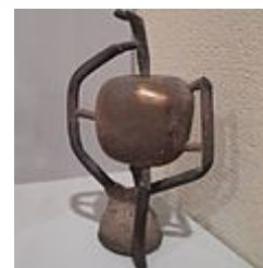
Kovový odlitek před začištěním dělicí roviny a stop po vtokách
