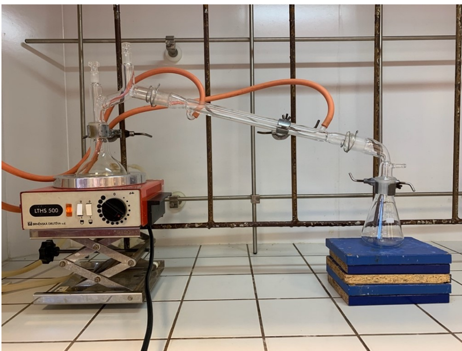
Obrázek č. 24: Příprava vzorku pro destilaci s vodní parou (nahore) a aparatura pro tuto destilaci (dole).
