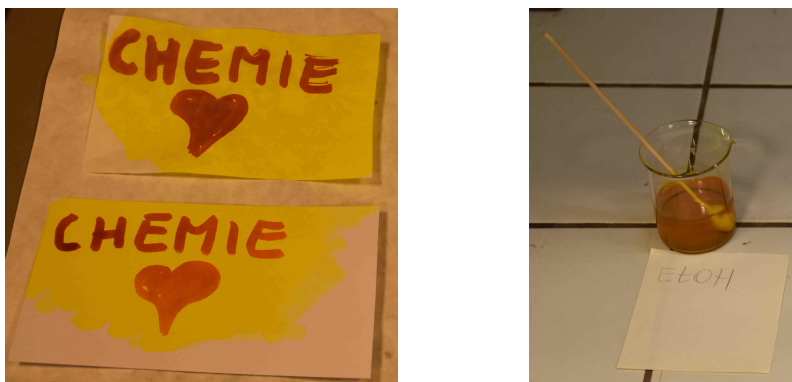
Obr. 10: Nápis provedený roztokem jedlé sody na filtračním papíru (vlevo nahoře) a kreslícím kartonu (vlevo dole) po vizualizaci pomocí extraktu z kurkumy (vpravo).
