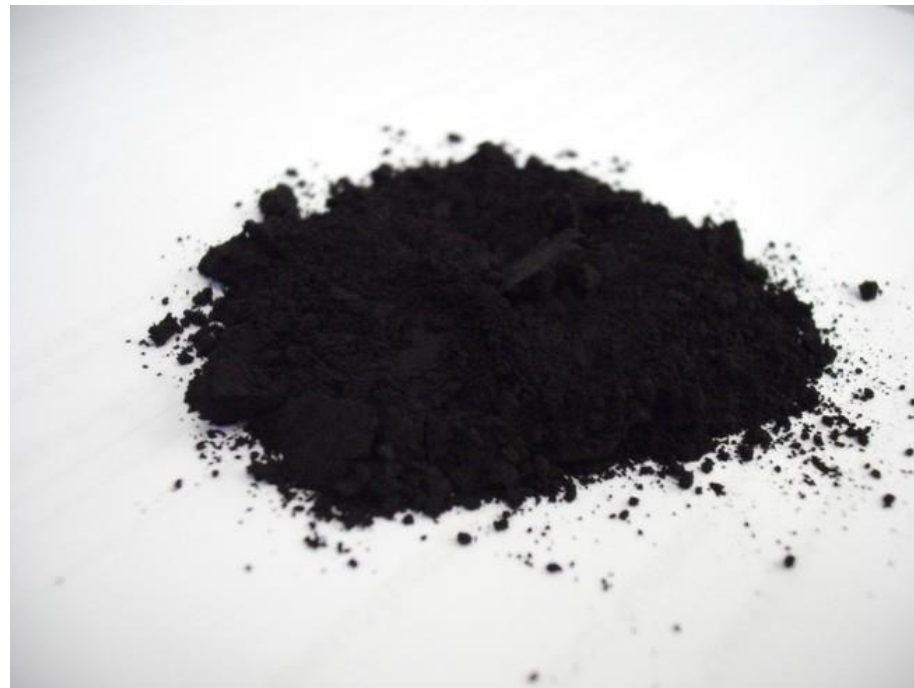
\text{Fe}_3\text{O}_4 ( \text{Fe}^{\text{II}}\text{O} \cdot \text{Fe}_2^{\text{III}}\text{O}_3 ) - oxid železnato-železitý (magnetit)
