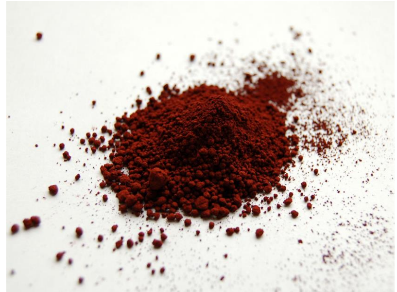
\text{Fe}_2\text{O}_3 \cdot n\text{H}_2\text{O} –hydratovaná forma oxidu železitého (limonit, hnědel)
