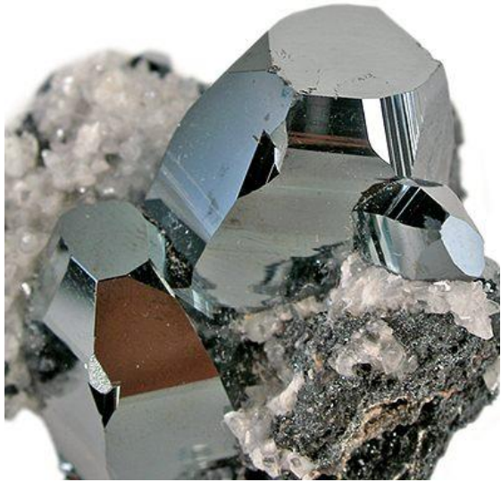
\text{Fe}_2\text{O}_3 - oxid železitý (hematit, krevet)
