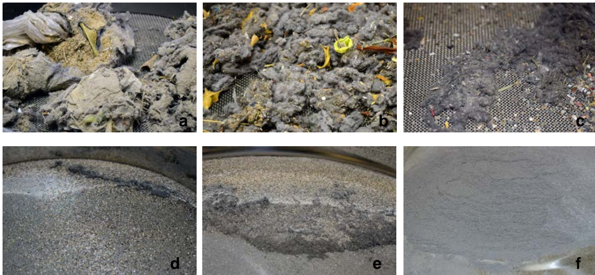
Obr. 2: Prach ze sáčku z vysavače a) před prosíváním, podle velikosti částic b) >2\text{ mm} , c) 2\text{ mm} > x > 1\text{ mm} , d) 1\text{ mm} > x > 0,5\text{ mm} , e) 0,5\text{ mm} > x > 0,25\text{ mm} a f) 0,25\text{ mm} > x . 5
