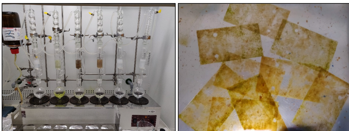
Obrázek 2: Vlevo – Sestavená aparatura pro extrakci silikonových gum – 250ml baňka se špičkou, Soxhlet se silikonovými gumami poskládanými do harmoniky, chladič. Vpravo – Neočištěné silikonové gummy po expozici.
