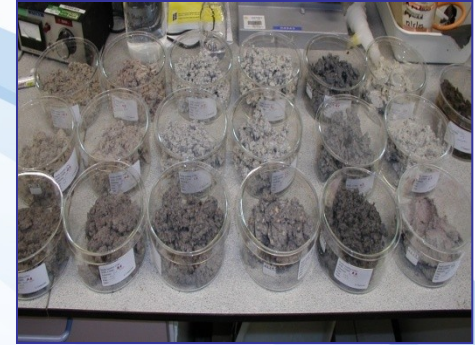
Ovlhčená půda rozvážena do testovacích nádob
