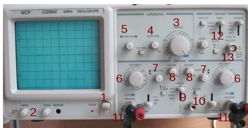
Obrázek B.1: Osciloskop MCP CQ5640. Čísla označují umístění ovládacích prvků zmíněných v textu.
