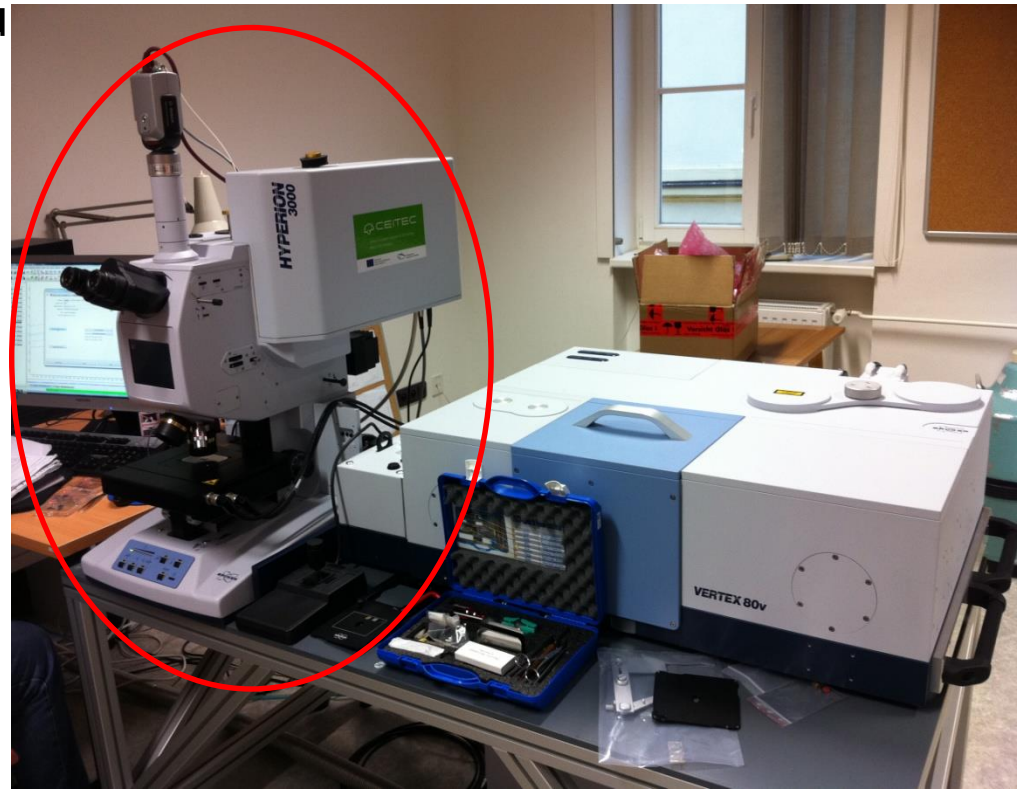
Infračervený mikroskop Bruker Hyperion 3000 (CEITEC)
