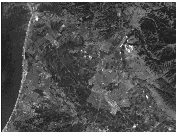
Obr. 7: Snímek pořízený ve viditelné části spektra – vlnová délka (0,6–0,7 micronů, tj. očima vnímaná jako červená barva), je vhodný pro identifikaci zástavby, půd a vegetace.
