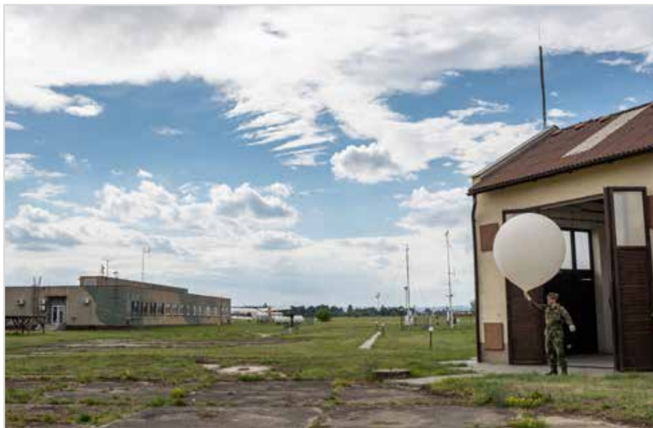
Obr. 4 Vypouštění balonu s radiosondou na pracovišti radiosondážního průzkumu v Prostějově
