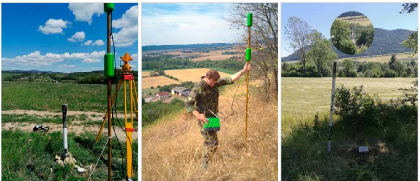
Obr. 14 Magnetické měření na primárním geomagnetickém bodě (vlevo), měření magnetického profilu v okolí magnetické anomálie (uprostřed) a primární geomagnetický bod Žacléř s detailem kostela jako orientačního bodu (vpravo) (foto R. Kopecký)
