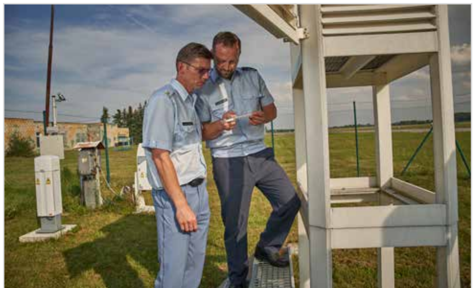
Obr. 10 Provádění kontrolního měření teplotních čidel na letišti Pardubice
