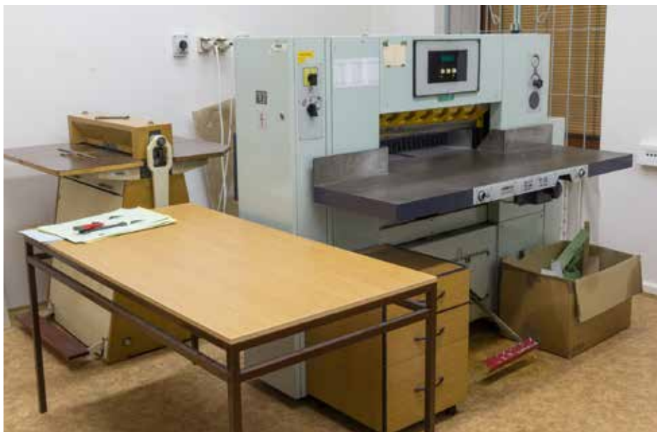
Obr. 8 Řezačka na pracovišti tiskárny (foto L. Čtvrtníček)
