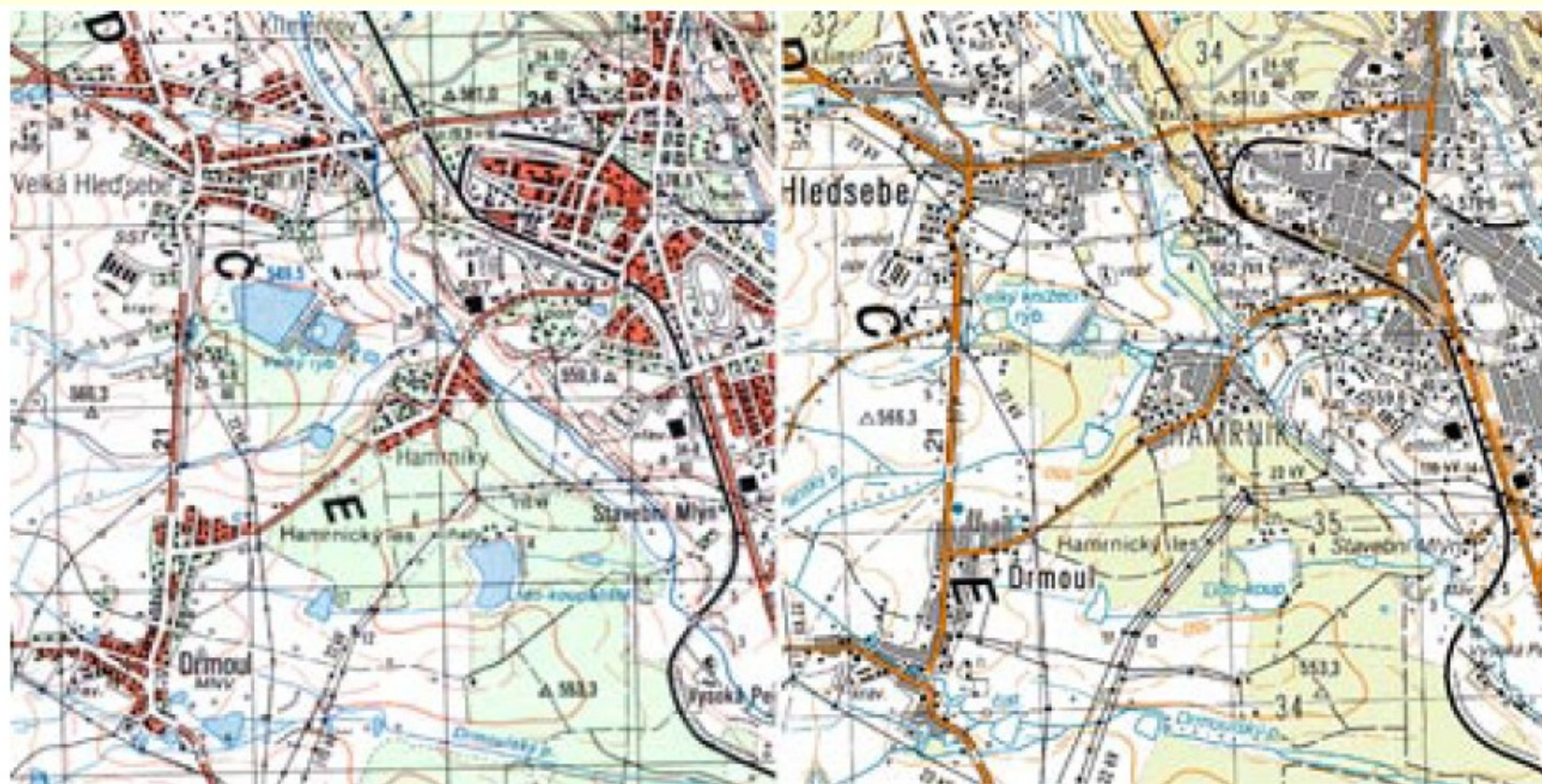
Obr. 10 Porovnání vzhledu topografických map měřítka 1 : 25 000 v systému S-42/83 a WGS84
