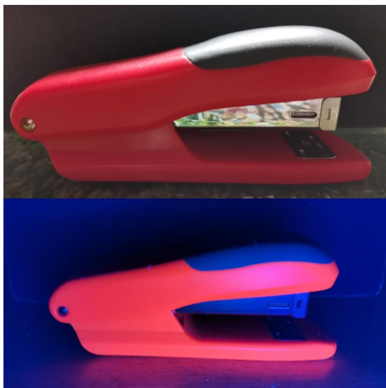
Obr. 37: Fluorescence plastů na sešíváče
