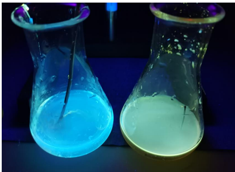
Obr. 8: Fluorescence CQD ve vodě
