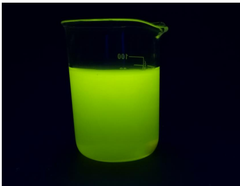
Obr. 21: Fluorescence doplňku stravy s obsahem riboflavinu ve vodném roztoku
