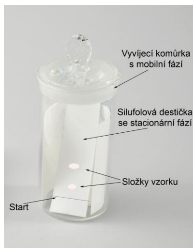
Obr 3-30 Umístění chromatografické destičky ve vyvíjecí komůrce
