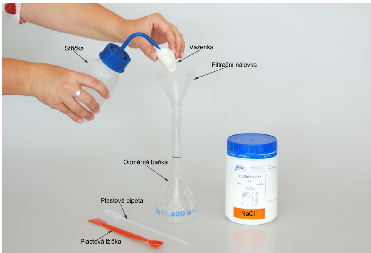
Obr 3-1 Příprava odměrného roztoku NaCl-splachování navážky do odměrné baňky.
