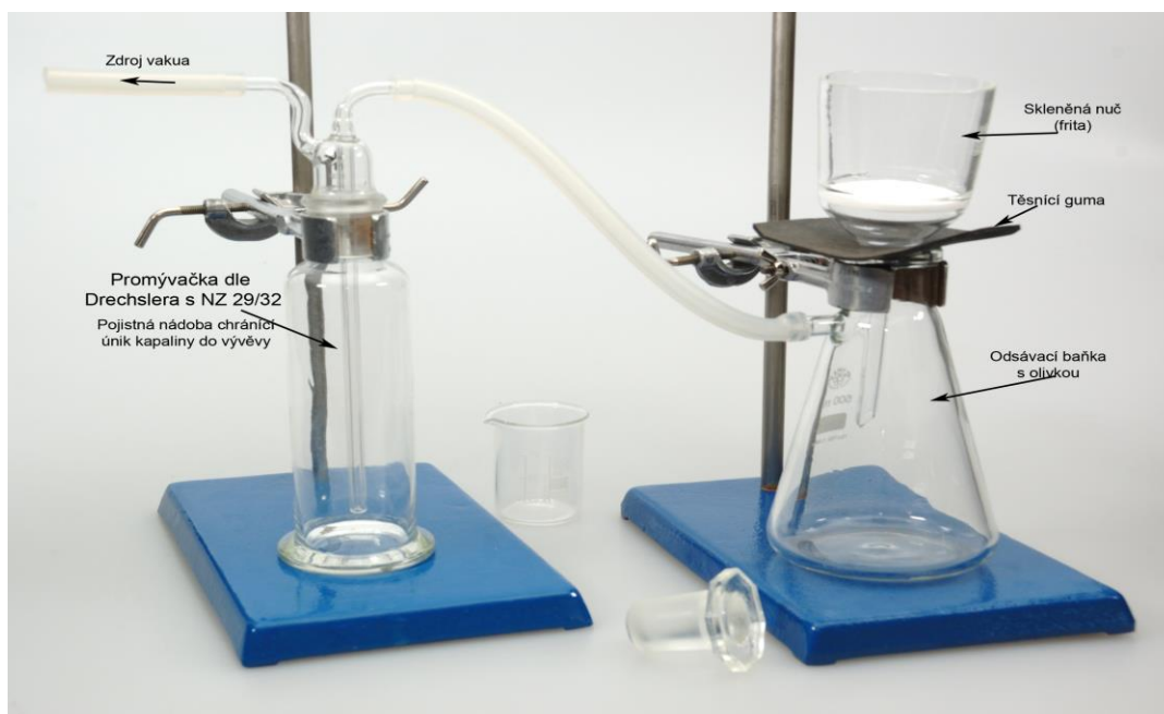
Filtrace za sníženého tlaku na skleněné nuči (fritě)
