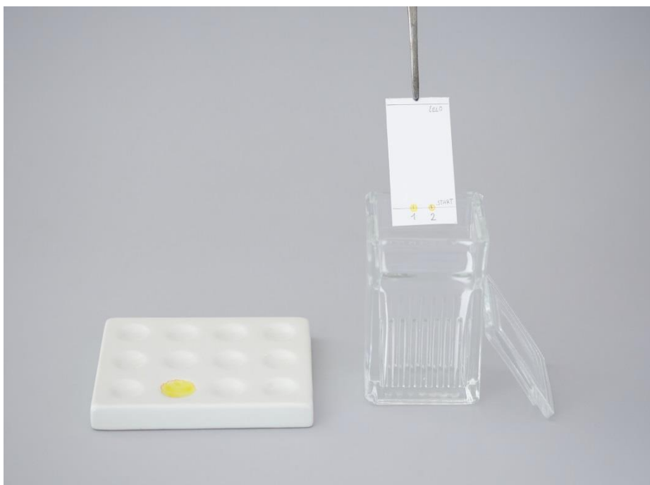
Obr 2- 37 Technika vkládání Silufolové destičky do vyvíjecí komory.
