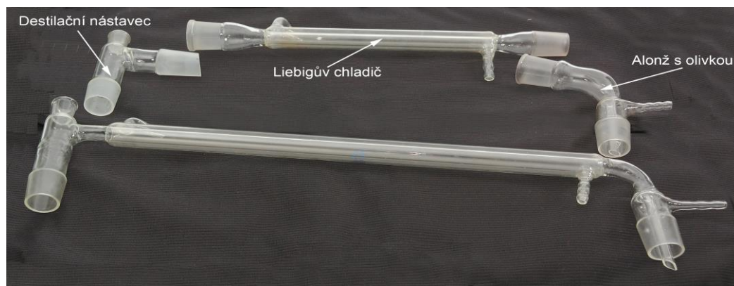
Jednotlivé části destilačního mostu + destilační most
