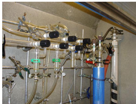
9-2 Rozvod inertní plyn/vakuum pro techniku Schlenkových nádobek.
