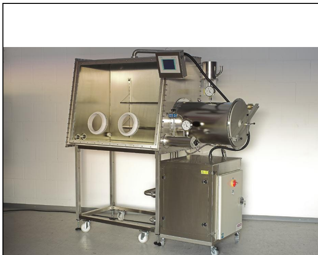
9-1 Rukavicový suchý box vybavený velkou i malou přestupní komorou
