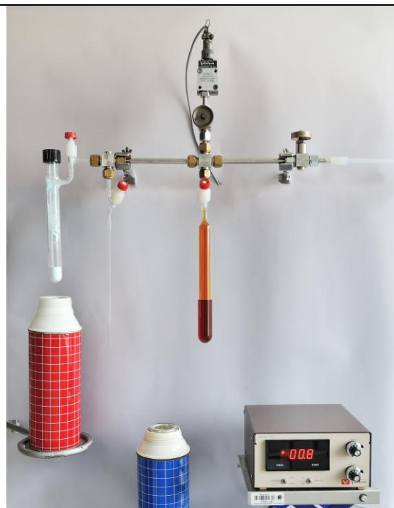
9-2 Rozvod inertní plyn/vakuum pro techniku Schlenkových nádobek.
