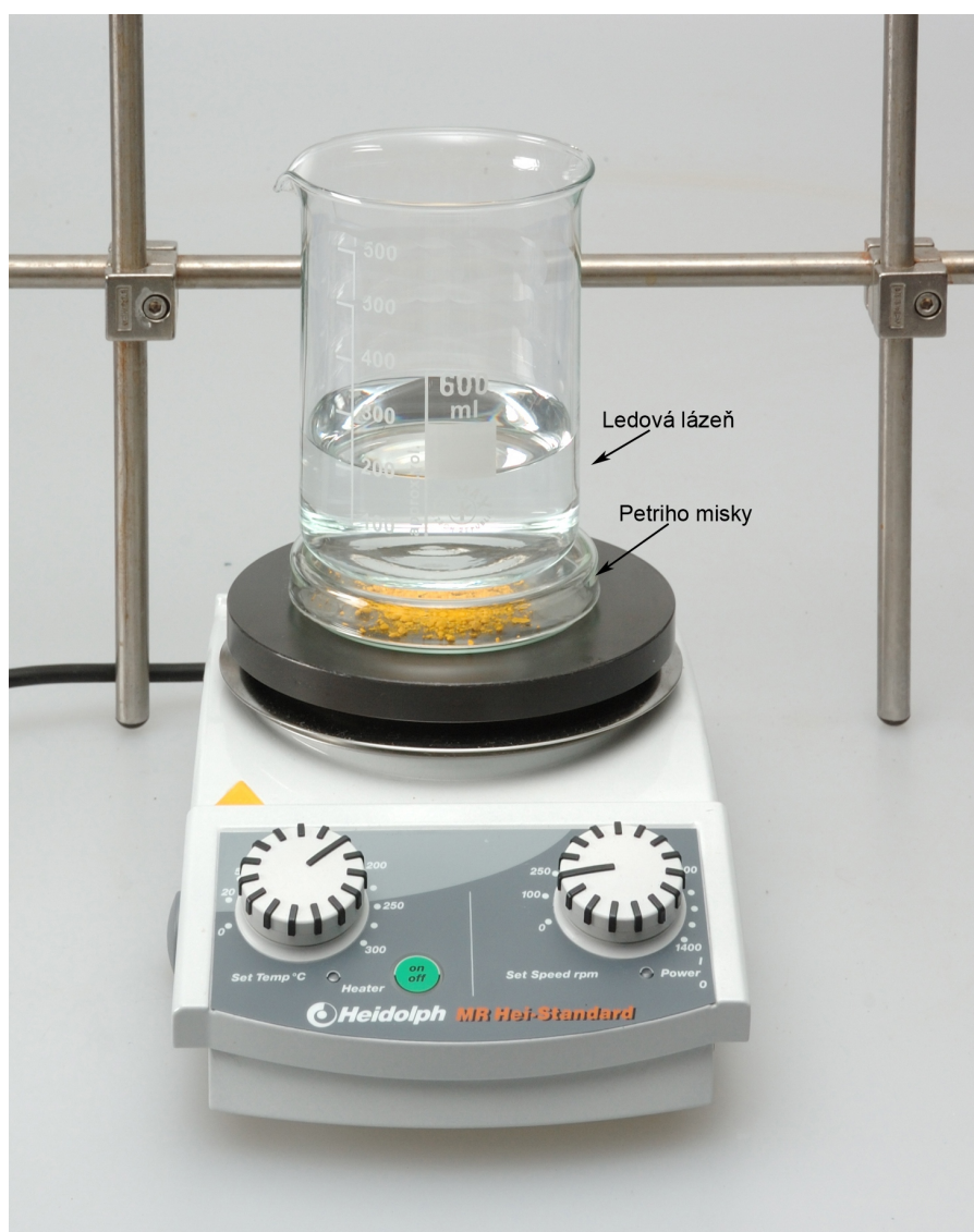
Obrázek 20: Aparatura pro sublimaci ferrocenu.
