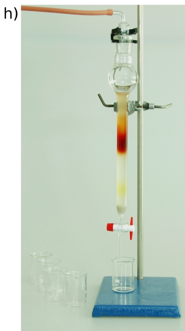
Obrázky 36e–h: Dělení azobarviv pomocí sloupcové chromatografie.
