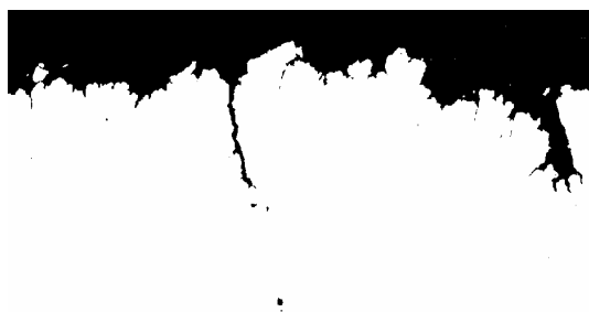
Obr. 2.35: Transkrystalová koroze oceli (zvětšeno 500 x)
