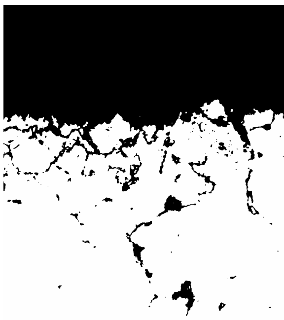
Obr. 2.34: Mezikrystalová koroze oceli tř. 14 ve vodném prostředí s obsahem síranových iontů
