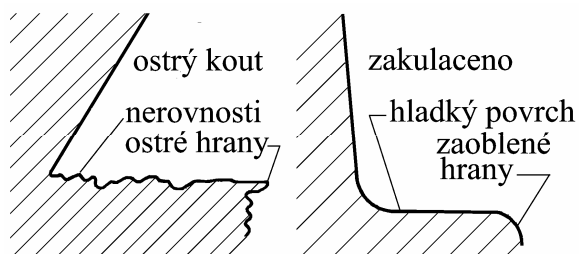
Obr. 2.26: Řešení geometrie povrchu; nesprávně (vlevo), správně (vpravo)
