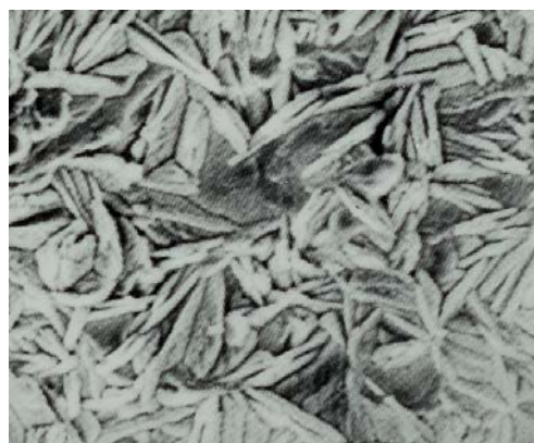
Obr. 3.5: Struktura fosfátové vrstvy
