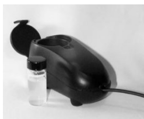
Obr. 11.2: Nefelometr TRB-BTA s lahvičkou formazinového standardu
