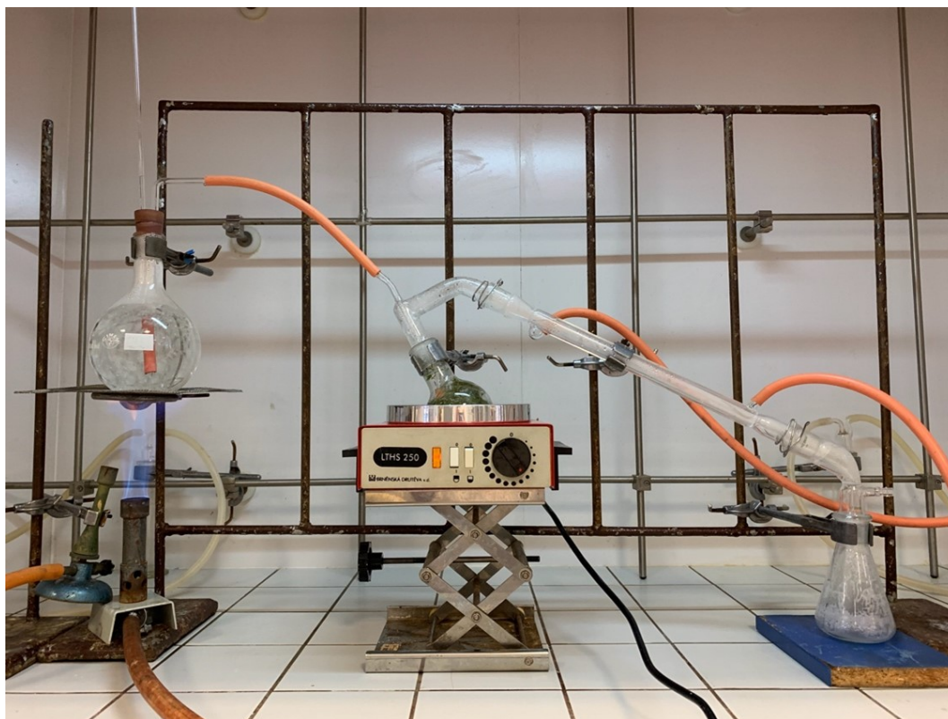
Obrázek 25: Destilační pro destilaci s vodní parou na aparatuře s vyvíječem vodní páry.
