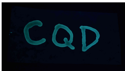
Obr 19: Nápis provedený roztokem CQD ve viditelném světle (vlevo) a pod UV lampou při 366 nm (vpravo).
