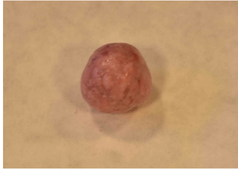
Obr. 7: Hopsací kulička z vodního skla obarvená potravinářským barvivem.
