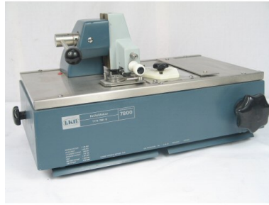
Obrázek 51: Knife maker – přípravek pro lámání skleněných desek pro výrobu skleněných nožů.
