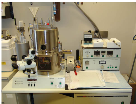
Obrázek 63: Přístroj pro dosažení hlubokého a rychlého zamražení ve vakuu (RMC RFD-9010 Freeze Fracture System).
