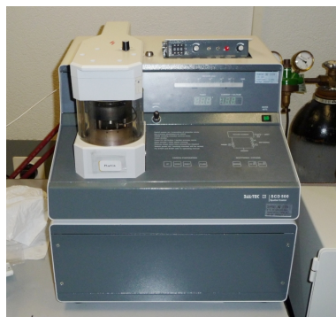
Obrázek 68: Naprašovací zařízení (SCD – Sputtering coater device).
