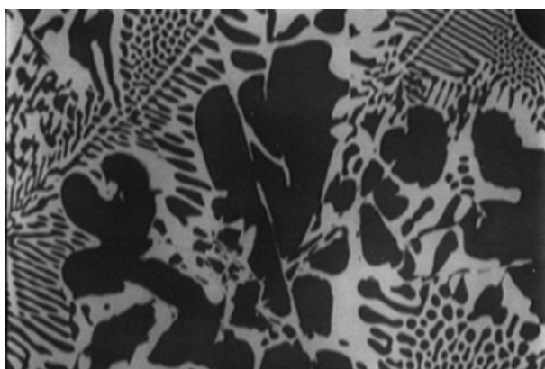
Obrázek 28: Odlišení oblastí materiálu na řezu slitiny Al-Cu v režimu zpětně odražených elektronů (BSE) Al ( Z = 13 ) – tmavší oblasti, Cu ( Z = 29 ) – světlejší oblasti.
