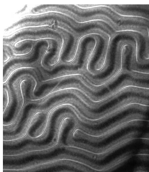
Obrázek 29: Magnetické domény v materiálu NdFeB.
