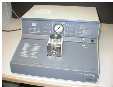
Obrázek 71: Zařízení pro sušení preparátů metodou obejití kritického bodu.
