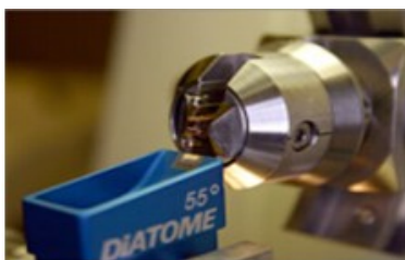
Obrázek 50: Pozice nože proti bločku ve výkyném držáku.
