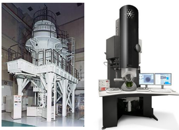
Obrázek 3: Dřívější a dnešní konstrukce TEM s vysokým rozlišením.
