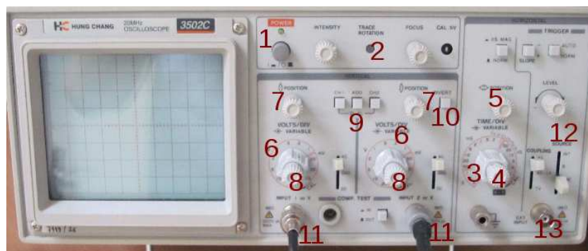
Obrázek B.2: Osciloskop Hung chang 3502C. Čísla označují umístění ovládacích prvků zmíněných v textu. Knoflíky 4 a 8 jsou umístěny ve středu přepínačů 3 a 6.
