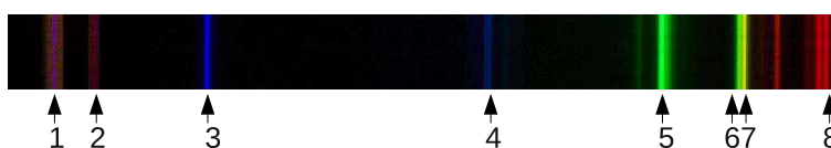
Obrázek 9.4: Upravená fotografie spektra rtuťové výbojky. Očíslovány jsou čáry, jejichž vlnové délky jsou uvedeny v tabulce 9.1.
