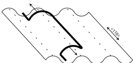
Obrázek 5.4 Mechanismus difúze kinků pro materiály s vysokým třením mřížky (kovalentní krystaly, bcc za nízkých homologických teplot).
