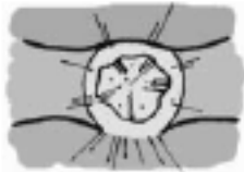
(d) End of the discharge : plasma implosion, removing of the molten metal pool
