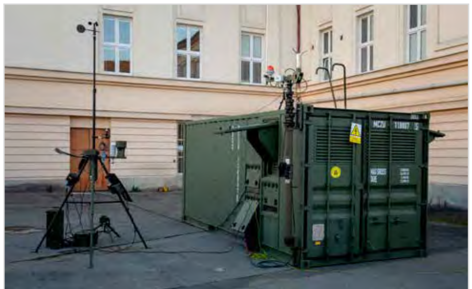
Obr. 1 Kontejner modernizované mobilní meteorologické stanice Oblak I s taktickým přenosným měřicím a pozorovacím meteorologickým systémem MAWS 201M TACMET [foto: archiv VGHMÚŘ]
