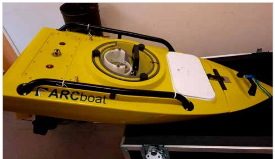
Obr. 4 Dálkově ovládaný člun určený k měření parametrů – teploty, rychlosti, průtoku, profilu dna apod. – vodních toků a ploch [foto: archiv VGHMÚř]
