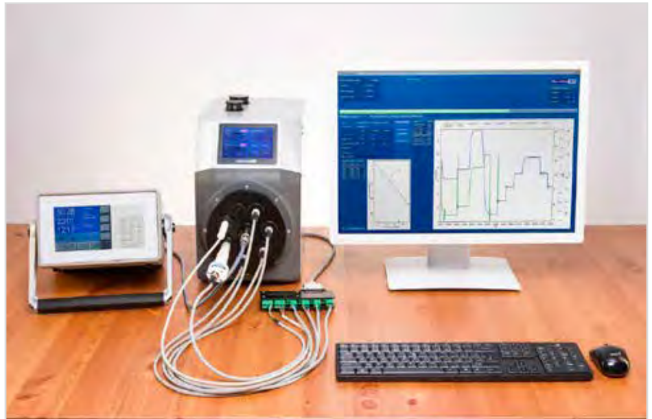
Obr. 3 Souprava kalibrátoru vlhkosti Humiwell se sondou Vaisala HMP155 (vlevo vlhkoměr MBW 473-SHX) [foto: archiv VGHMÚř]
