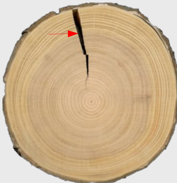
Boční výsušná trhlina u dřeva borovice (P řez)
