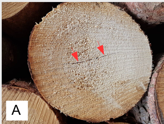
Trhlina čelní dřeňová jednoduchá (A) a složená (B).
