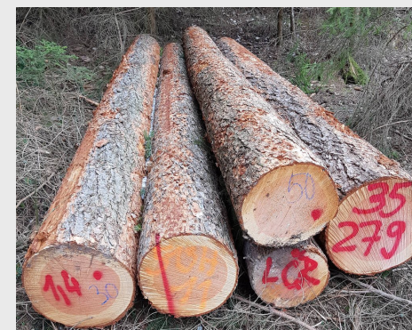
Normální sbíhavost – není vada dřeva
