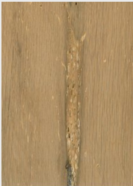
Požerky způsobené hmyzem
