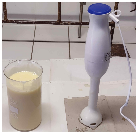
Obr. 34: Směs rostlinných tuků a roztoku NaOH po promísení pomocí tyčového mixéru.
