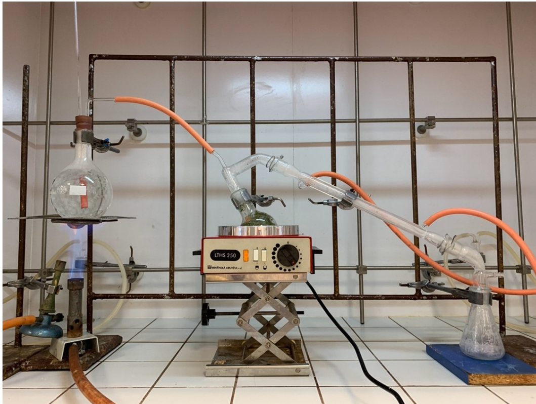
Obrázek 31: Destilační pro destilaci s vodní parou na aparatuře s vyvíječem vodní páry.
