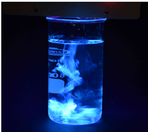
Obr 22: Fluorescence připravených uhlíkových nanočástic při 366 nm.
