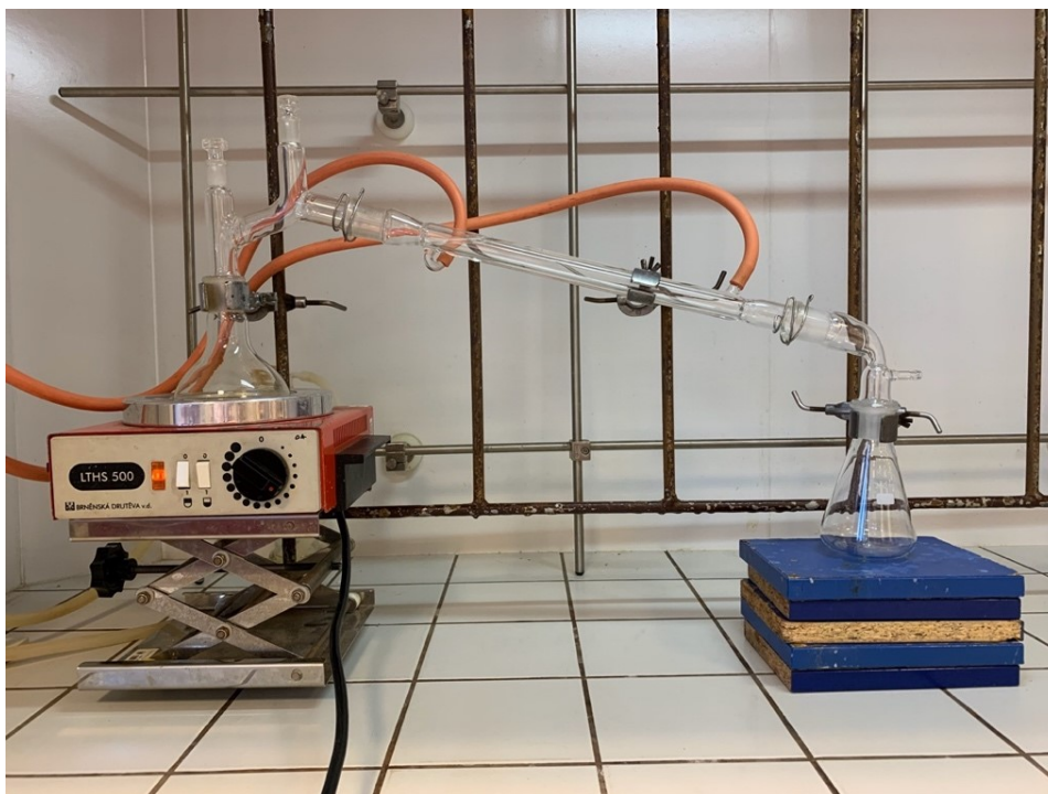
Obrázek 29: Příprava vzorku pro destilaci s vodní parou (nahore) a aparatura pro tuto destilaci (dole).
