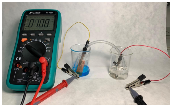
Obr. 73: Měření napětí článků s poločlánky v kádinkách.
