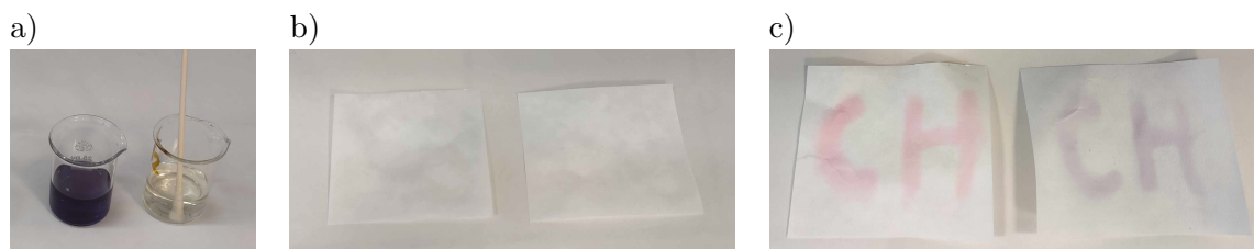
Obr. 8: (a) Vodný extrakt z červeného zelí (levá kádinka) odbarvený roztokem disiřičitanu sodného (pravá kádinka); (b) suchý nápis odbarveným extraktem na filtračním papíře; (c) vizualizace nápisů 10% roztokem kyseliny citronové (vlevo) a 10% roztokem síranu draselného-hlinitého.
