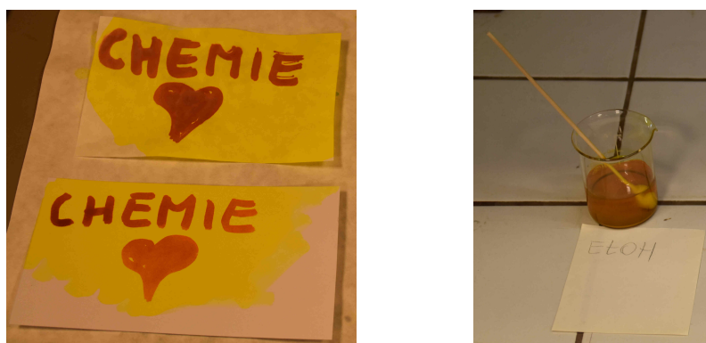
Obr. 14: Nápis provedený roztokem jedlé sody na filtračním papíru (vlevo nahoře) a kreslícím kartonu (vlevo dole) po vizualizaci pomocí extraktu z kurkumy (vpravo).
