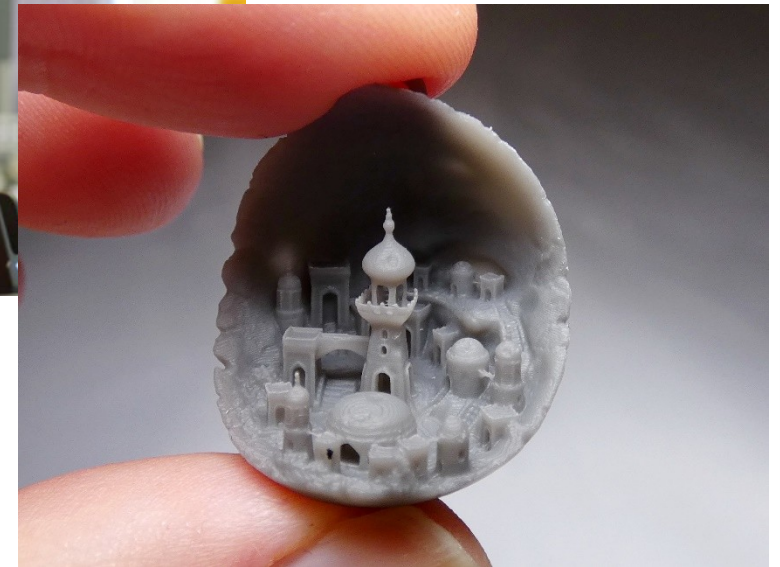
Obr. 5: Ukázka výtisku na SLA tiskárně 2
