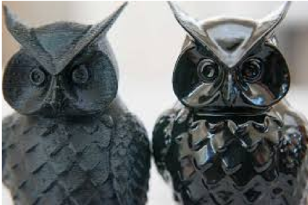
Obr. 11: Postprocessing tisku ABS s využitím acetonu
