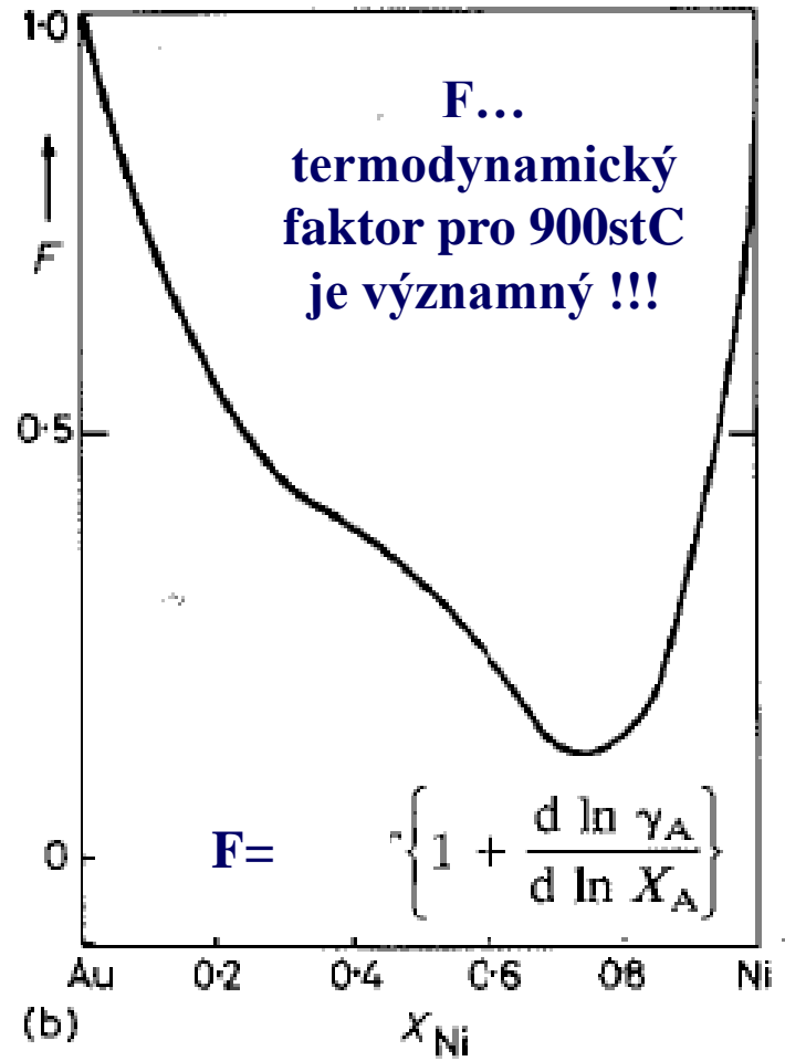
Fázový diagram Au-Ni a termodynamický faktor.
