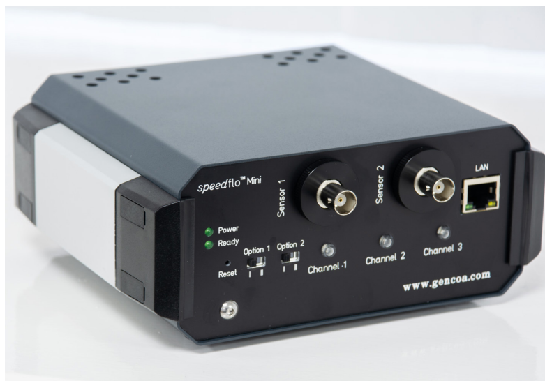
Obr. 7: Zariadenie pre spätnoväzobné riadenie Speedflo používané na ústave fyziky a technológii plazmy.
