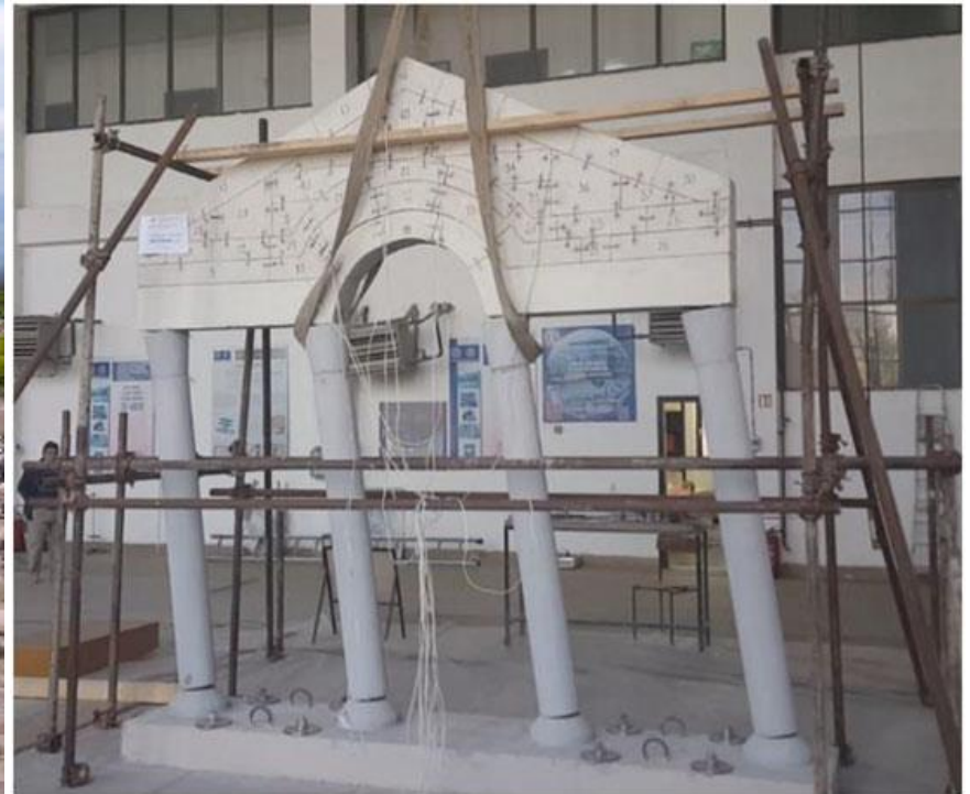
Test účinku zemětřesení ( a = 1.9 \text{ g} ) na sloupořadí (Nikolić et al. 2019).
