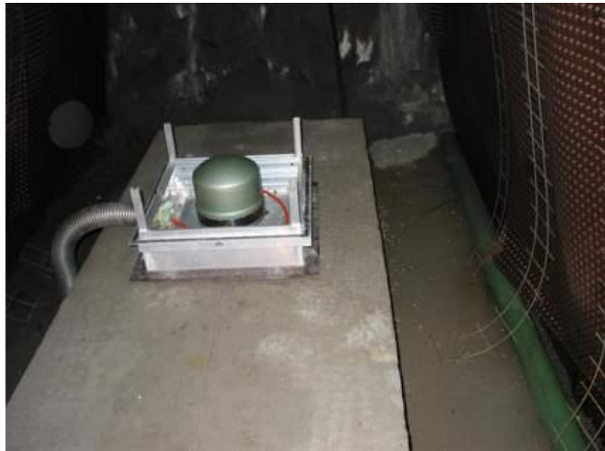
seismometr STS-2 firmy Streckaisen, dynamický rozsah ~ 140Db
