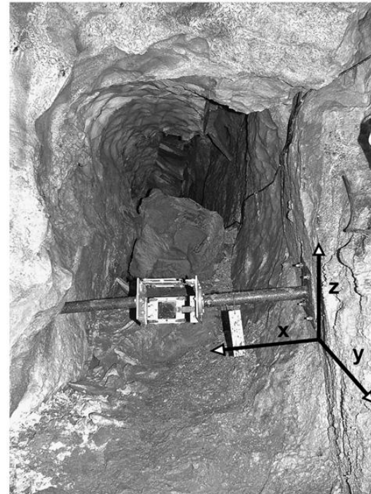
dilatometr TM71 v jeskyni Na Pomezí (Štěpančíková et al. 2008)
