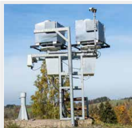
Bolidová kamera Astronomického ústavu Akademie věd ČR umístěná na stanici Sedloňov-Polom
