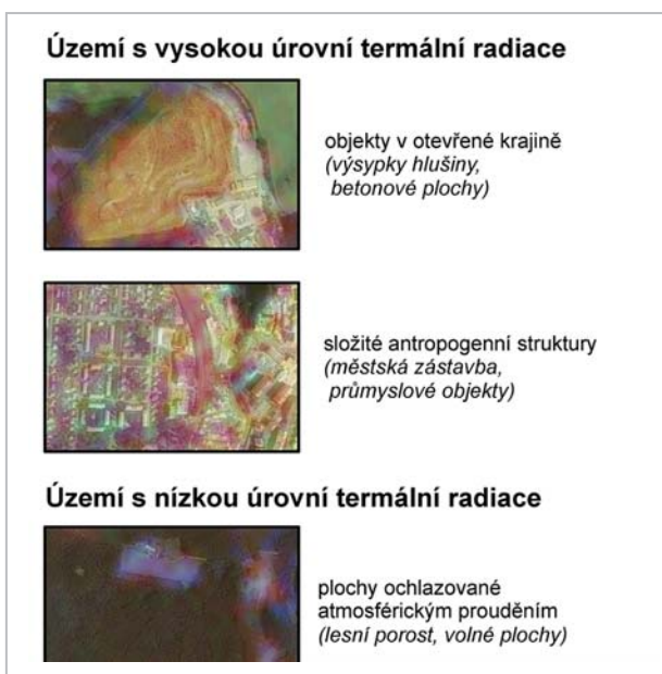
Obr. 7 Prototyp tematické ortofotomapy, ve které je tematická informace i topografický podklad součástí obrazové složky (TEMA3) – detail (vlevo), legenda (vpravo)
