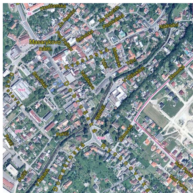
Obr. 4 Prototyp ortofotomapy města s popisem uliční sítě v měřítku 1 : 5 000 (TOPO2) – detail (vlevo), legenda a vedlejší mapa (vpravo)
