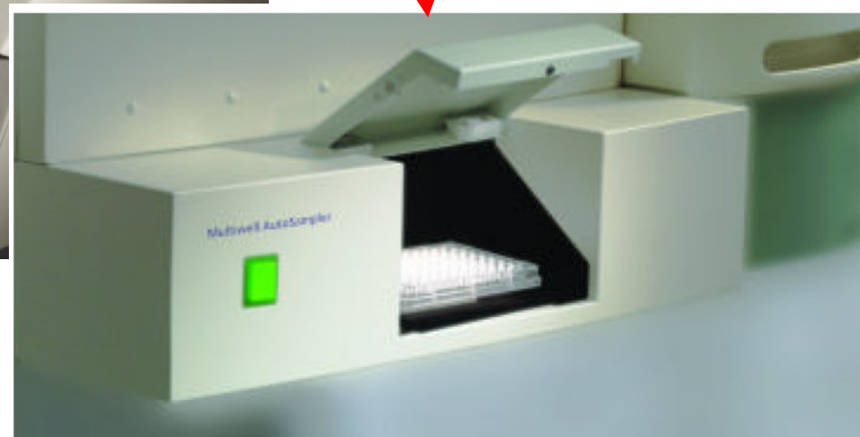
Adaptér pro nasávání vzorků z mikrotitrační desky
