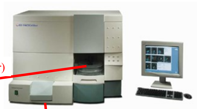
Adaptér pro nasávání vzorků z mikrotitrační desky
